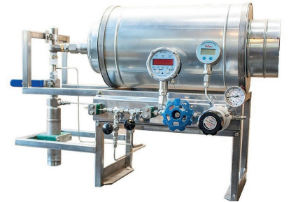
Рисунок 6. Стенд для настройки и пневмоиспытаний предохранительных клапанов
