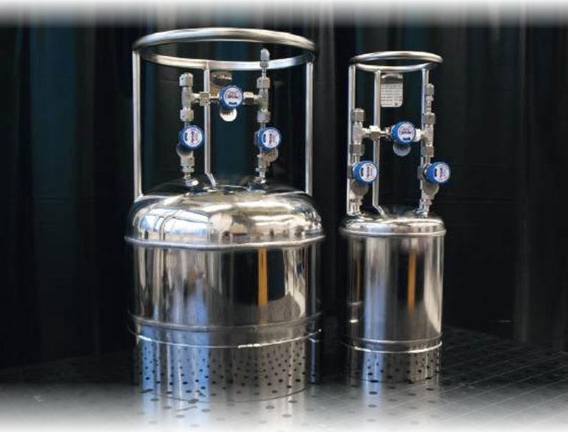
Рис. 3. Контейнеры с ЭХП для тетрахлорида германия объемом 40000 и 10000 мл и рабочим давлением 6 бар
