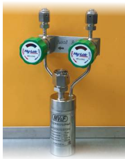
Рис. 6. Баблер объемом 150 мл с рабочим давлением 6 бар
