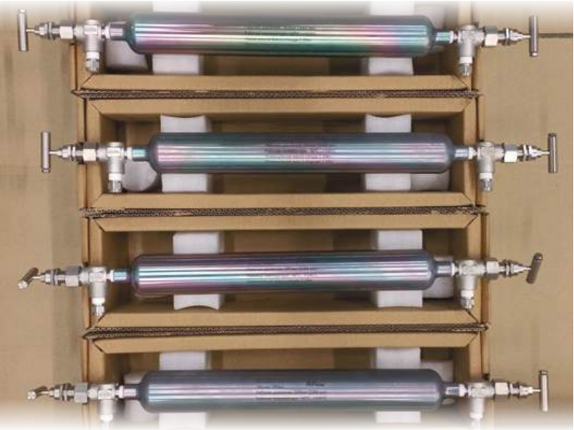
Рис. 13. Пробоотборные сосуды для природного газа объемом 300 мл с рабочим давлением 345 бар. Сульфидостойкое покрытие аморфным кремнием
